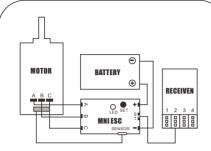
电池连接---连接电池时注意正负极位置。错误连接会 损坏电调和电池。如上图所示, 电调正极线连接电池 的正极, 负极线连接电池的负极。
